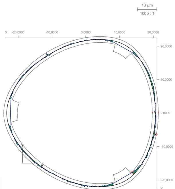
Die von einer unabhängigen Prüfstelle zertifizierte Polygonform unserer CORUM-Werkzeugaufnahme. Beachten Sie die nahezu perfekte Überdeckung der Soll- und Ist-Geometrie.
