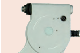
Verstelschroef voor meetklok ± 5 µm
