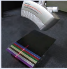
Meting van een kleurmonsterplaat
