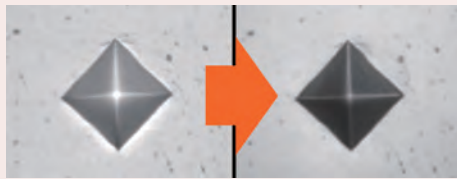
Observatiebeeld van de indrukking (50X) Vermindering van vertekening rond de indrukking
