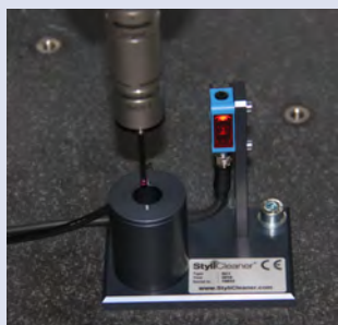
StyliCleaner, hogere nauwkeurigheid door schone tasters
