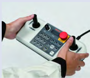
Optionele joystick-box M2 met regelknop voor snelheid
