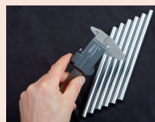
Schuifmaat met draadloos systeem U-WAVE fit
