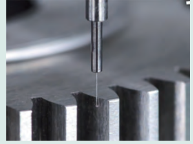
MPP-NANO module (0.8mm taster) met tandwiel meting
