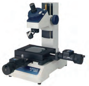
TM-505B met optionele digimatic inbouwschroefmaten
