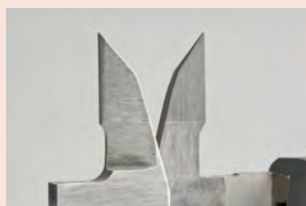
Meetbekken voorzien van hardmetaal
