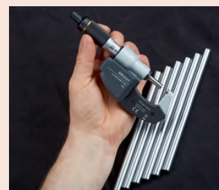
Met Draadloos Systeem U-WAVE fit
