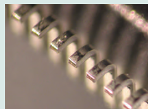
Meetvoorbeeld : Hoogte van verbindingspootjes op een QFP
