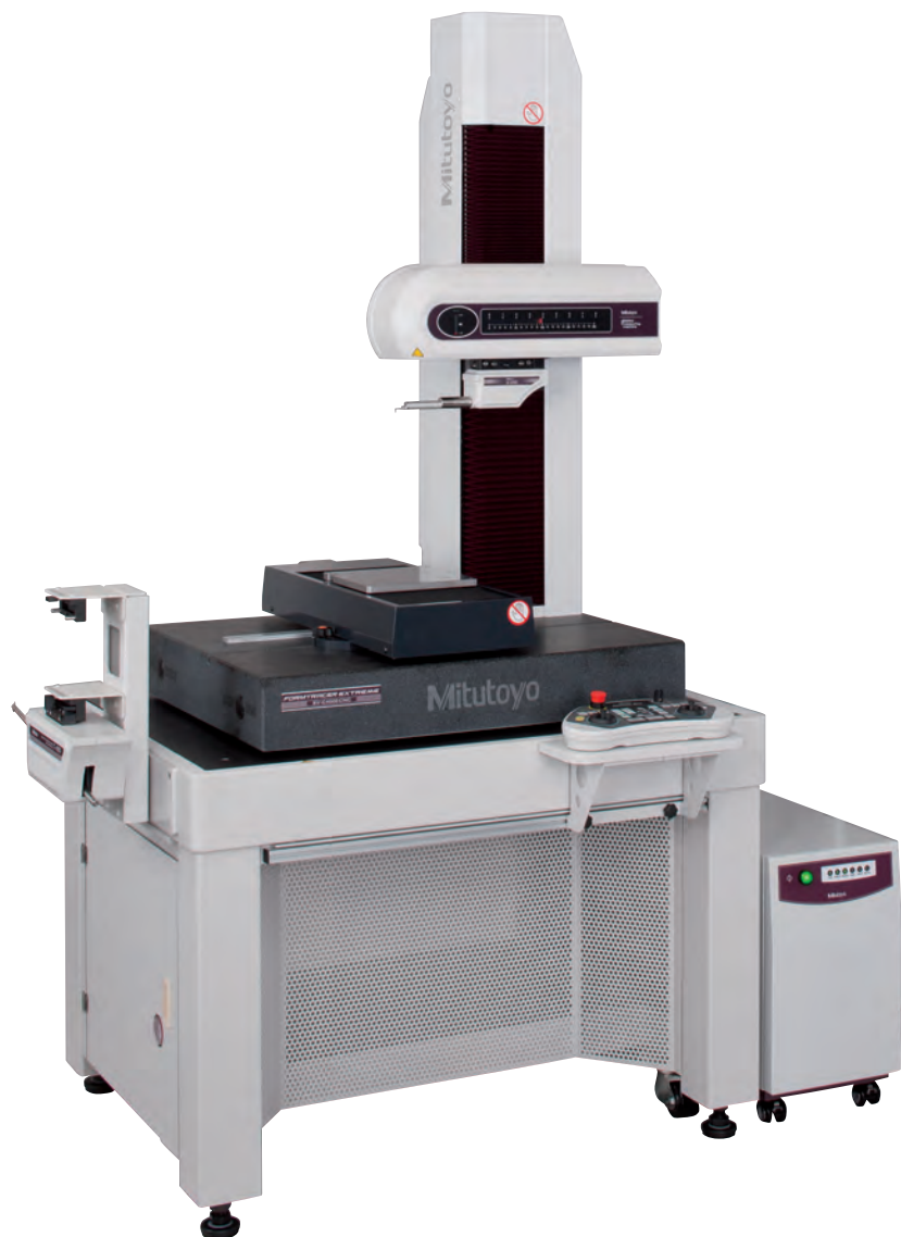
SV-C4500CNC uitgerust met twee krachtige verwisselbare aandrijfeenheden
