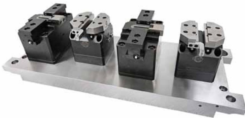
Kundenspezifische Spannvorrichtung mit 2 Stück BSH-100 (OP10) und 2 Stück BSHAN-155 (OP20). Mit dem Spanner BSHAN-155 werden die Werkstücke in der zweiten Aufspannung ausgleichend gespannt. In diesem Fall ist der Bezugspunkt der ausgleichenden Spannung eine Nut am Werkstück.
