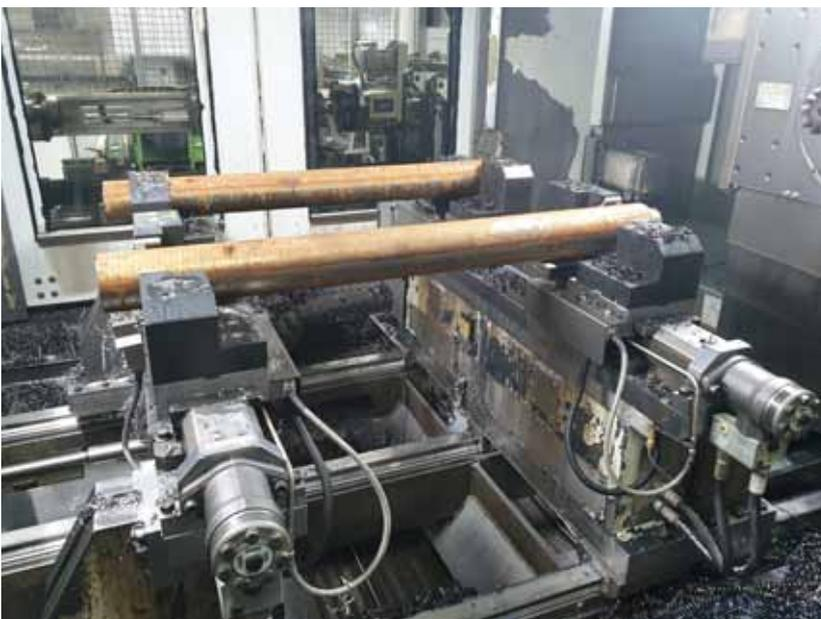
4 Stück BSMG-500-WS (Ausführung als Wellenspanner) zur Spannung von 2 Wellen. Die Spanner werden über einen hydraulischen Motor angesteuert, die Wellen werden per Roboter eingelegt.
