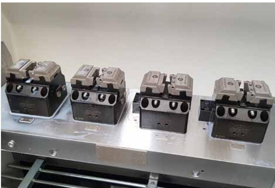
Voll automatisierbare Spannlösung für wechselnde Werkstücke.
