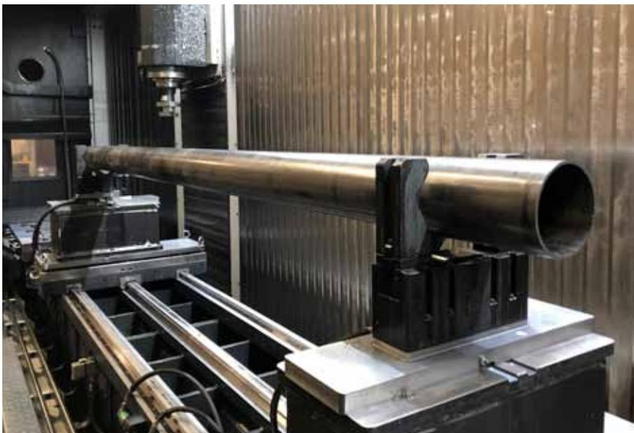
2 Stück BSH-290 spannen eine Welle. Der Spanner und die Backen wurden für den Kunden auf seine Anforderungen entwickelt. Gefordert war ein möglichst großer Hub. Mit dem BSH-290 können 15 mm Hub pro Backe realisiert werden.
