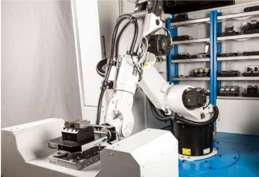
Automatisierte Anwendung des BSH-160 mit Pendelgrippbacken auf Palette.
