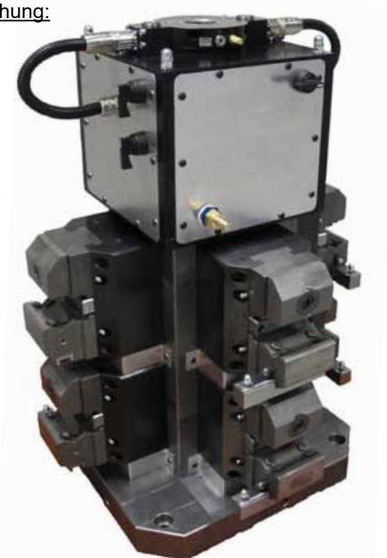
Auf einem Spannturm mit 8 Stück BSP-160 werden Wellen in einem horizontalen Bearbeitungszentrum gespannt. Dabei wurden die Spanner mit der Zusatzfunktion Spannwegüberwachung ausgestattet. Im Turmaufbau ist die komplette Steuerung untergebracht. Der Anwender kann zwischen automatischem und manuellem Betrieb wählen.
