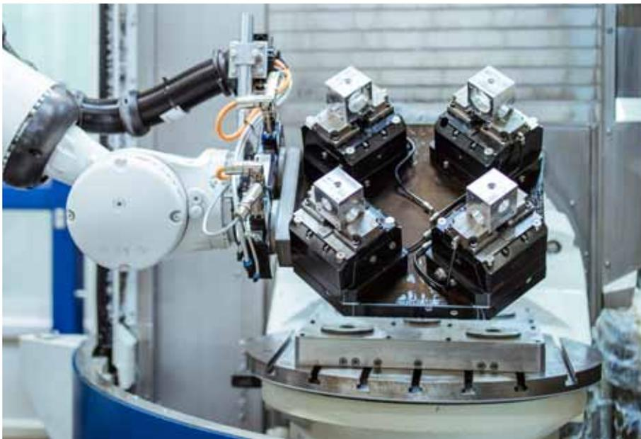
Aufspannung in einer modularen Roboterzelle von Vischer & Bolli. Abgebildet ist eine vierfach Palette mit den Spannern BSH-160.
