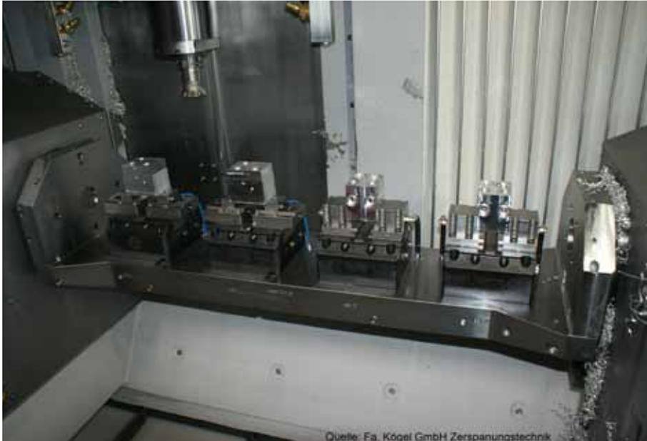
4 Stück BSH-160 auf einer Schwenkbrücke mit werkstückspezifischen Backen. Auf zwei Spannstellen erfolgt die Bearbeitung der OP10, auf der anderen die OP20.
