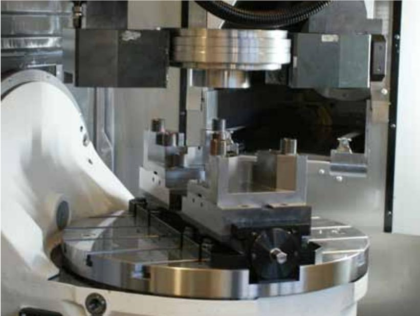
Der Spanner BSMG-500 wird automatisiert betrieben. Ein Roboter legt das Werkstück ein und betätigt die Gewindespindel zum Spannen mit einem Schlagschrauber.
