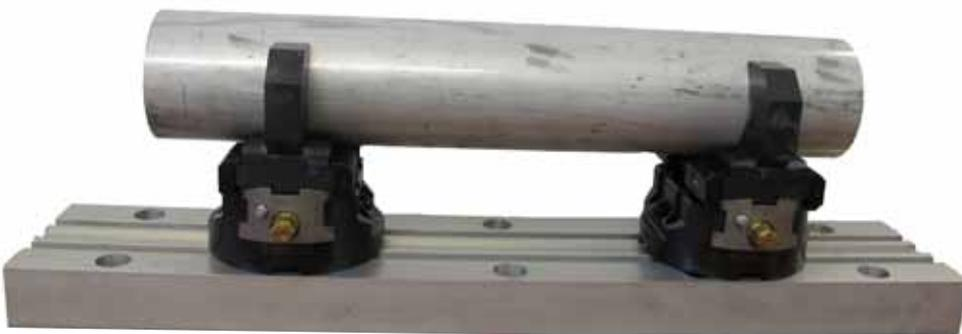
2 Stück BSM-140 mit Prismenbacken spannen eine Welle.
